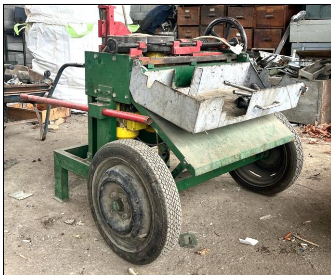
Слика 6. Машина за третман каблова
