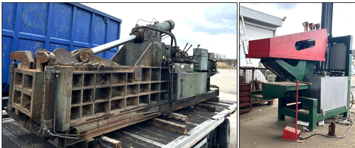
Слика 5. Опрема за третман металног отпада (преса (лево) и „алигатор“ маказе (десно))
