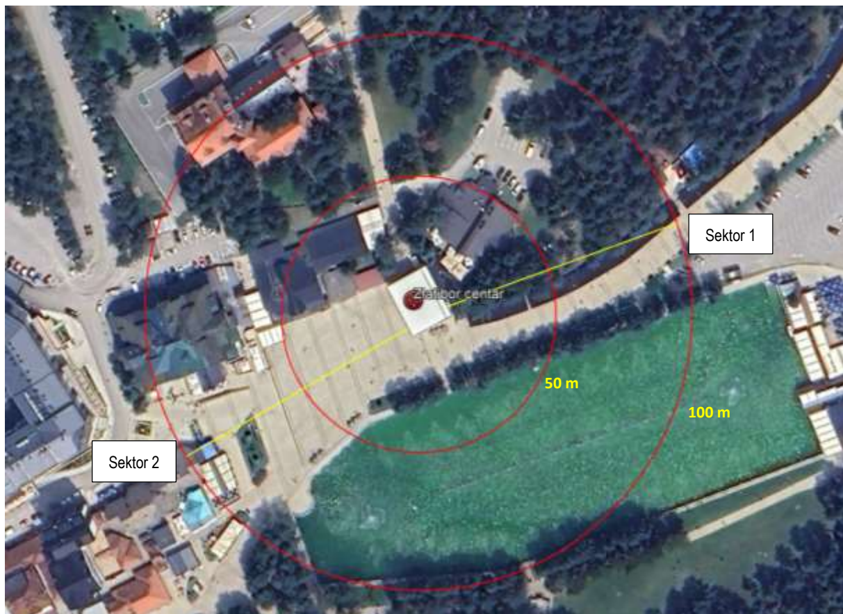
Slika 2.5 Pravci zračenja antenskog sistema buduće BS ZLATIBOR CENTAR
